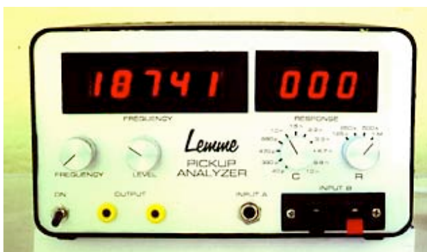
Fig.12. El "analizador de la pick up" ® - el primer instrumento disponible comercialmente que mide la respuesta en frecuencia de pickups magnéticos.
