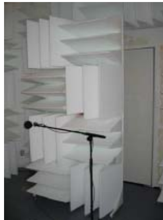
Figura. 5.3 Cámara anecoica utilizada para medir la respuesta de campo libre
