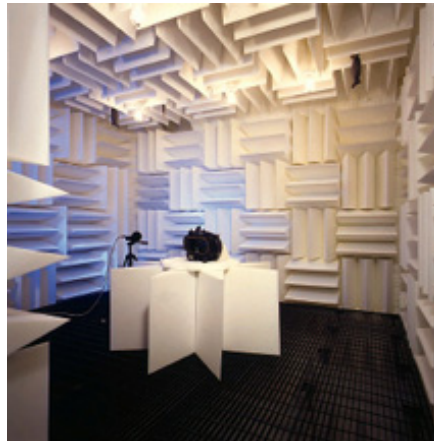
Figura. 5.8 Fotografía del interior de una cámara anecoica.
