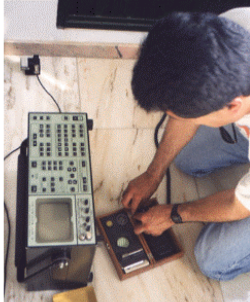
Figura 2.2 Fotografía del Analizador de Vibraciones BRÜEL & KJÆR Tipo 2515 utilizado en medición de la aceleración en la parte superior de un edificio.
