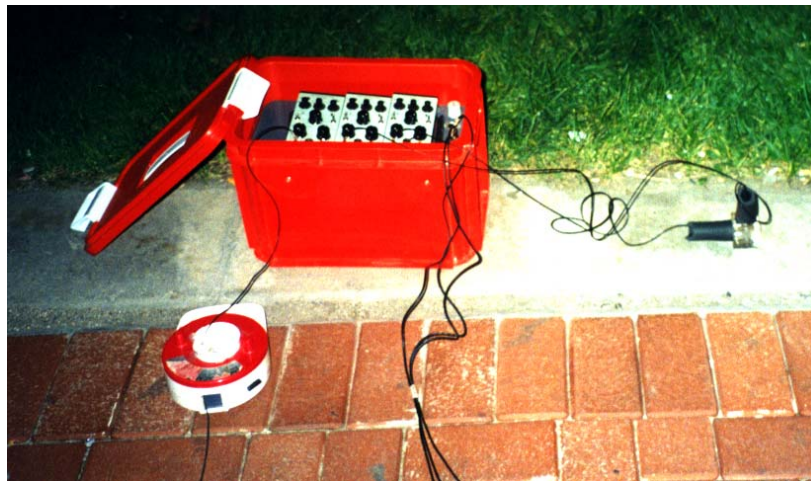
Figura 2.9 Amplificador, sensores y cables durante una medición de un edificio.
