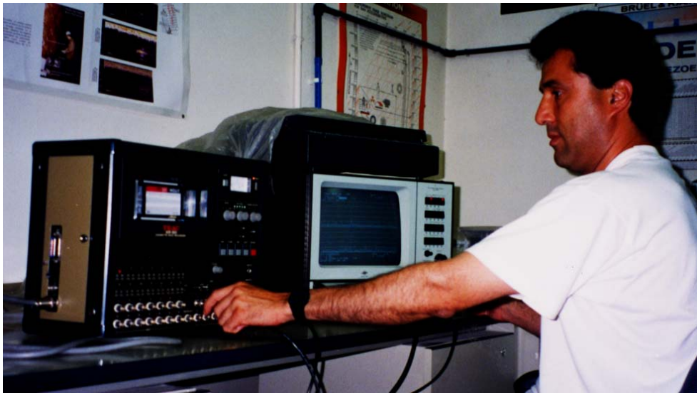
Figura 2.6 Fotografía del registrador en cinta de vídeo de 14 canales TEAC XR-50 (izquierda) y del analizador de dos canales BRÜEL & KJÆR Tipo 2034 (derecha).
